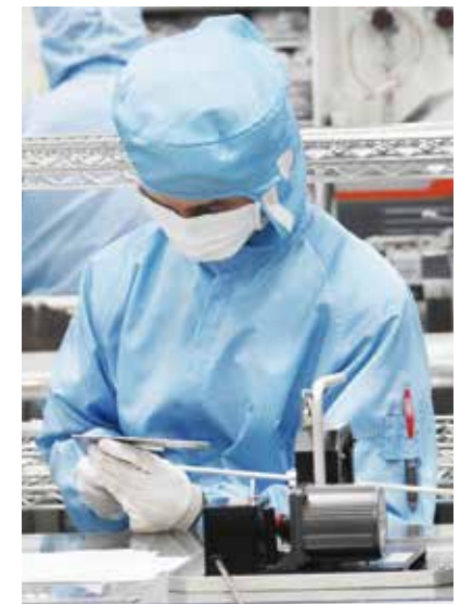
▲ Gia công ống mao mạch nhỏ tại phòng sạch
